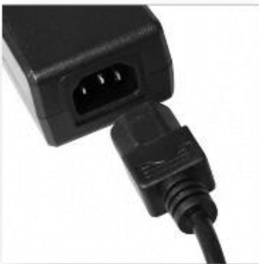
Rys. Sposób podłączania kabla zasilającego do zasilacza
