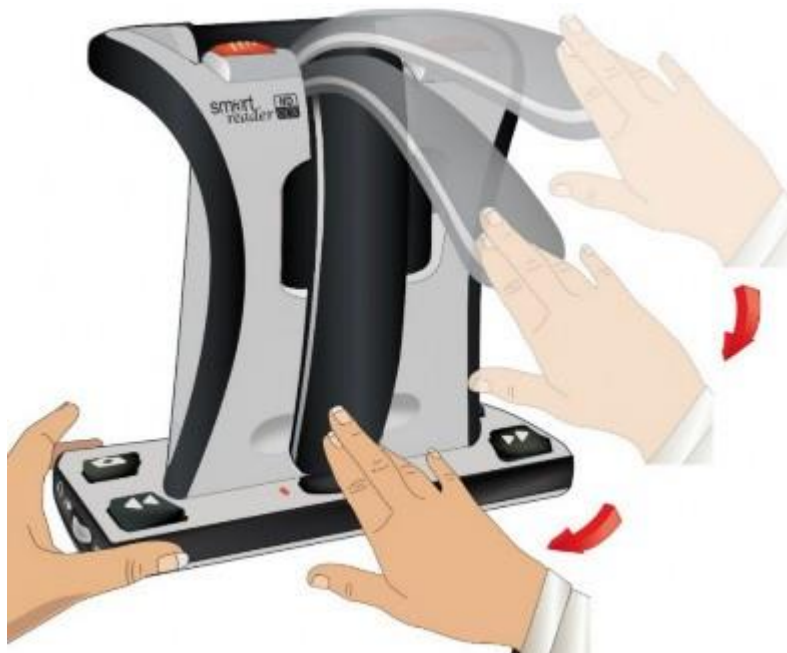
Rys. Sposób opuszczania ramienia kamery OCR, aż do pełnego zamknięcia ramienia i zablokowania go na miejscu
