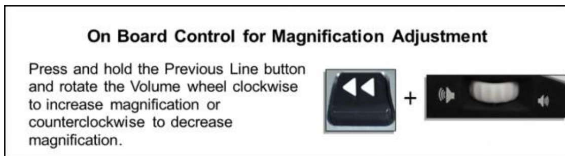
Rys. Regulacja poziomu powiększenia przy użyciu przycisku poprzednia linia i jednoczesnego obracania pokrętła głośności
